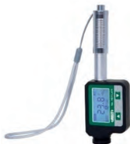
INSIZE HDT-L411 přenosný tvrdoměr.
