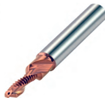
Stopkové frézy 3v1 - vrtá, frézuje závit, sráží hranu chlazené středem nástroje
